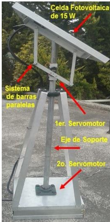
Seguidor Fotovoltaico de 15 W.
